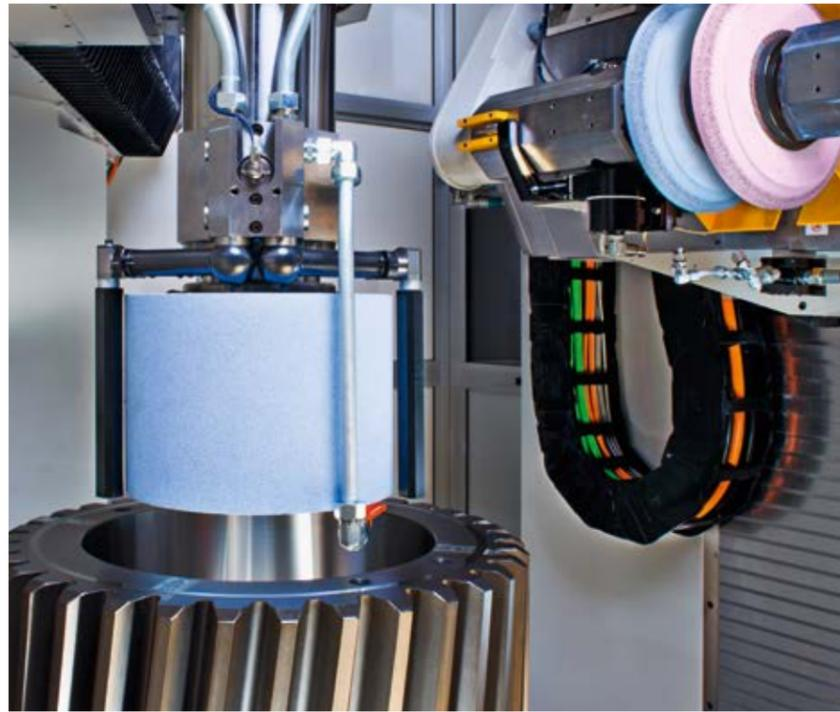
ZP B für Außenverzahnungen, Bohrungen und Planflächen in einer Aufspannung
