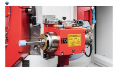
wälzgelagerten und wartungsfreien Motorspindeln mit stufenloser Drehzahlregelung sowie der neusten Generation von Anfunksensorik. Die Wellenenden nehmen Aussenschleifscheiben mit Durchmesser 500 mm und Breite 63 (80 F5) mm auf. Zum Innenschleifen setzen Sie leistungsfähige Hochfrequenzspindeln mit 120 mm Aussendurchmesser ein. Sie haben die Wahl: konfigurieren Sie den Schleifspindelstock nach Ihren individuellen Bedürfnissen.
